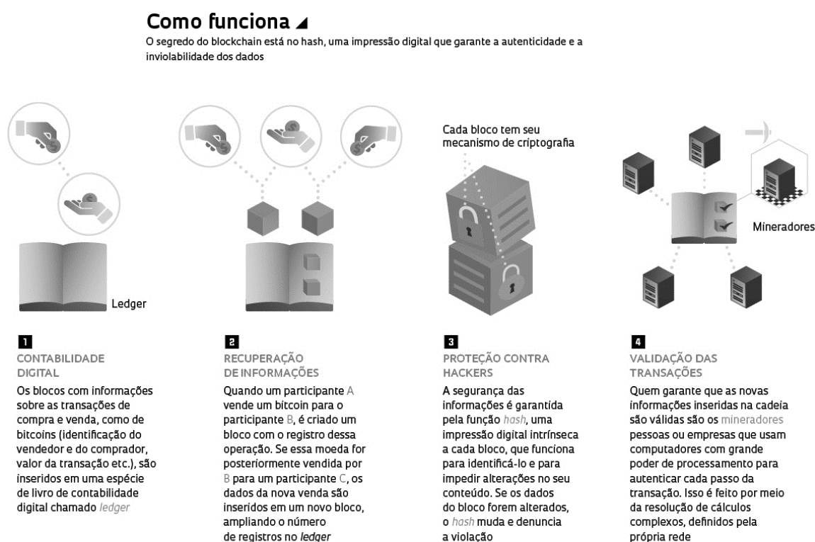
Figura 1. Funcionamento da Blockchain . Fonte: Otubo (2019).
