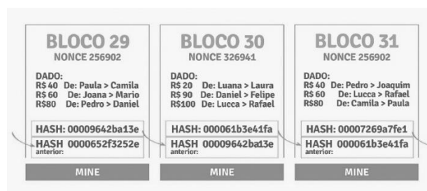
Figura 2. Modelo simplificado de blocos de Blockchain . Fonte: Junges (2018)
